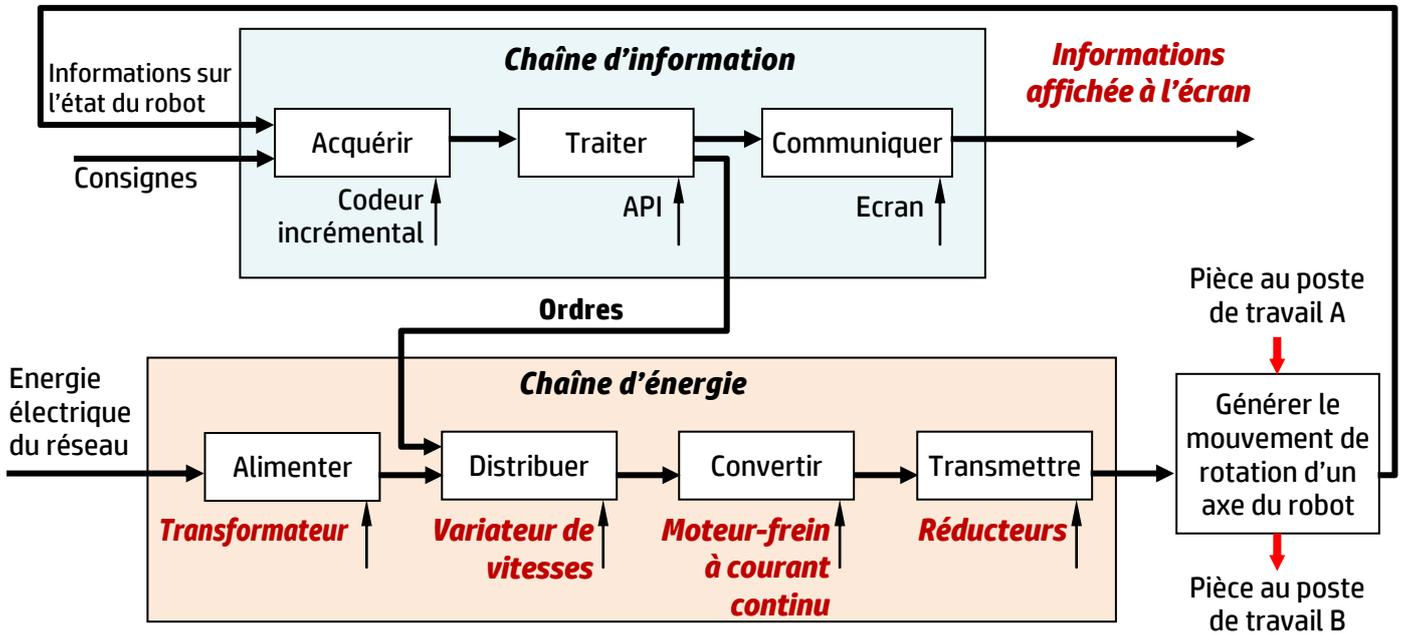
**Tâche 1.2 :** Analyse technique de quelques pièces de la chaîne de transmission du lacet (10) :
