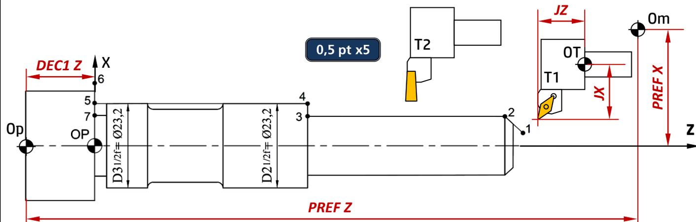
b- Compléter en mode absolu G90, en se référant au croquis des points caractéristiques du parcours d'outil ci-dessus et au dessin de définition de l'arbre moteur (16) DRES page 14/14, le tableau des coordonnées (dimensions moyennes) des points caractéristiques du profil fini : /2,5 pts
