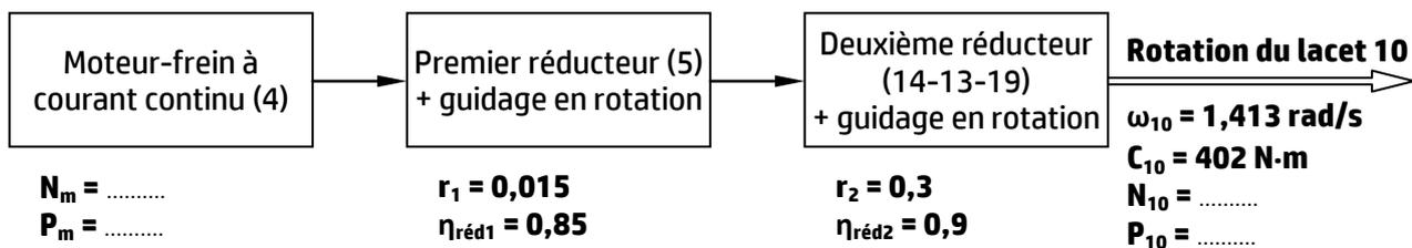
a- Calculer la fréquence de rotation  $N_{10}$  (en tr/min) du lacet (10). /0,5 pt
