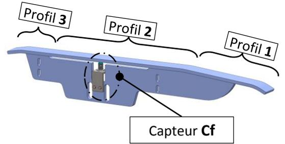
Phases permettant l'ouverture ou la fermeture des mors de la pince de serrage
