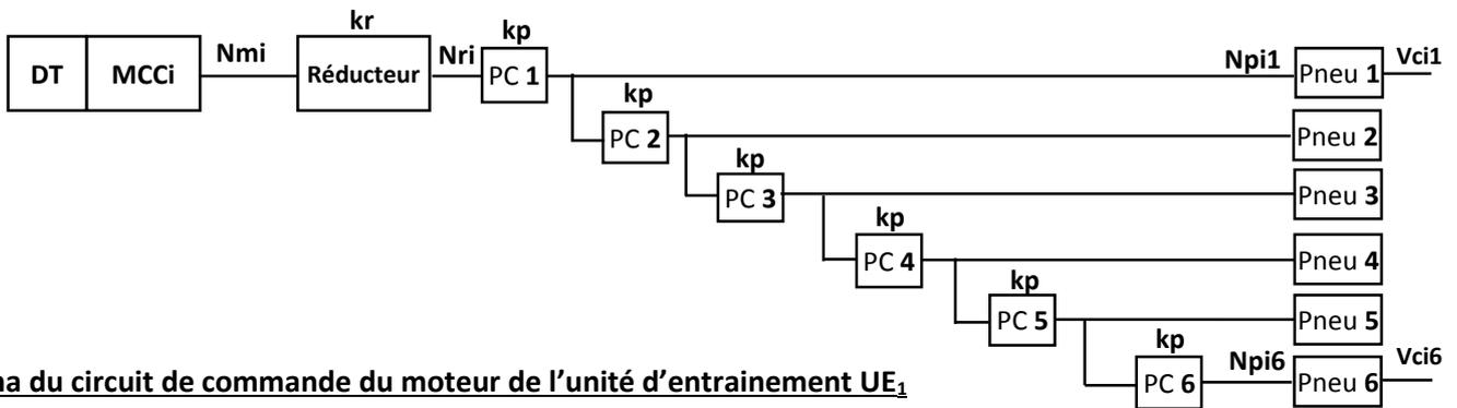
Schéma du circuit de commande du moteur de l'unité d'entraînement UE<sub>1</sub>
