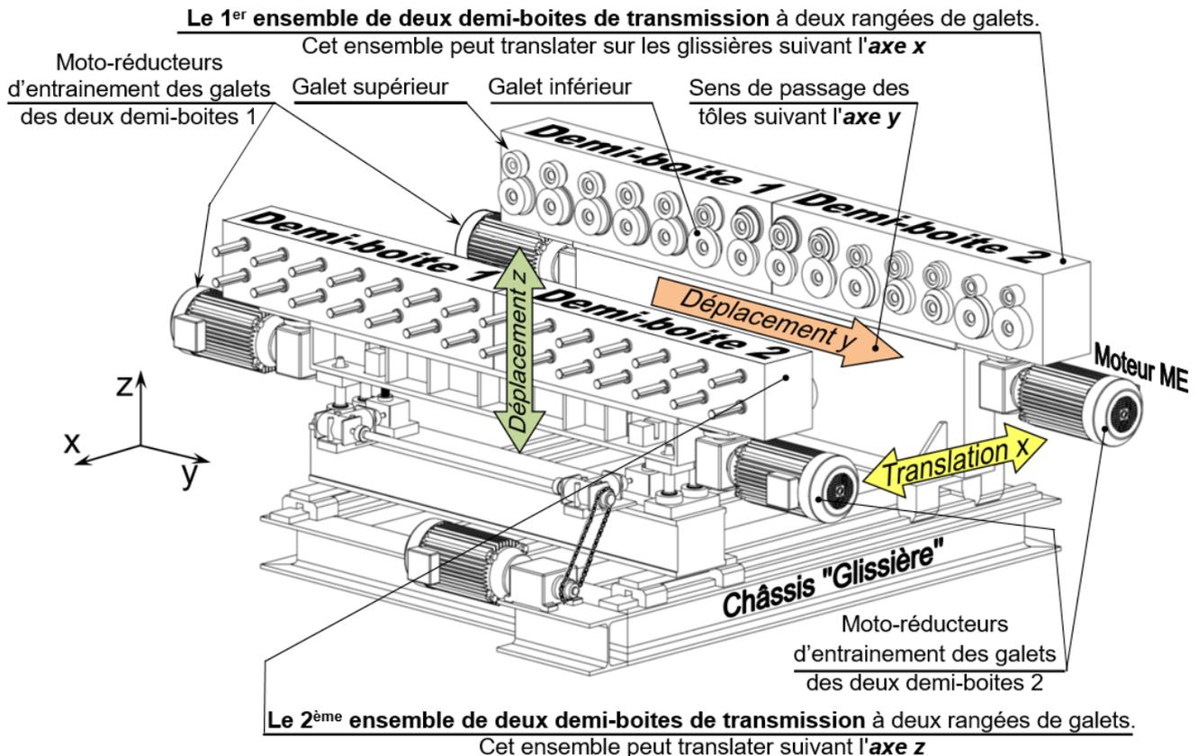
Selon la forme de la tôle (grande largeur ou petite largeur), la profileuse doit être réglée en largeur de profilage par l'opérateur. Pour cela, l'opérateur agit sur le **1<sup>er</sup>** ensemble des deux **demi-boîtes de transmission** pour le faire translater horizontalement suivant l'**axe x**, sur les glissières du châssis. **Voir figures (page 2/18)**
