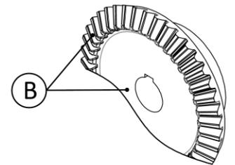
La géométrie des dents est obtenue par forgeage
