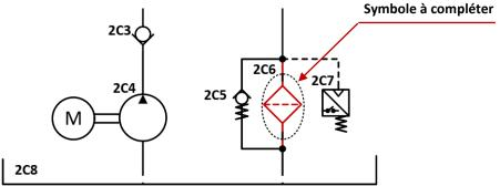
**Q.20.** Circuit hydraulique à compléter dans les deux phases de montée rapide et de descente lente.
