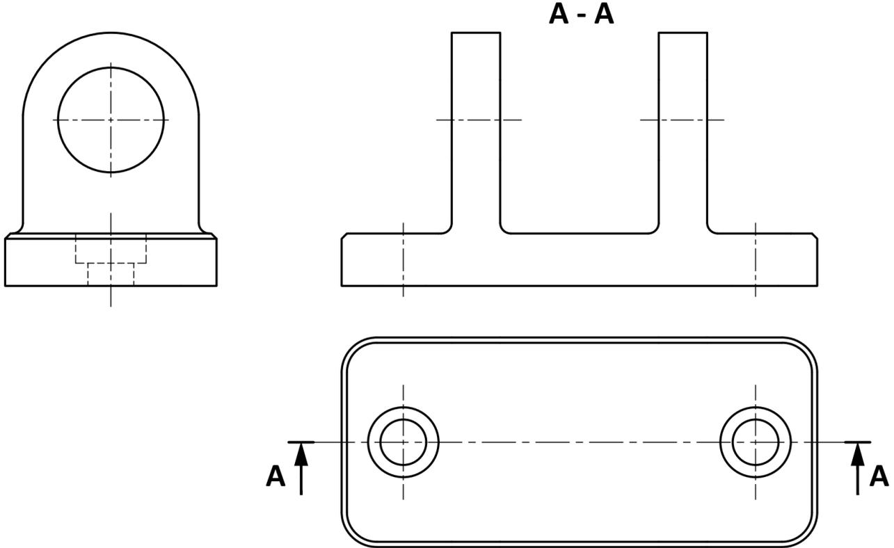
Représentation 3D et 2D de la liaison entre le vérin hydraulique et le module horizontal
