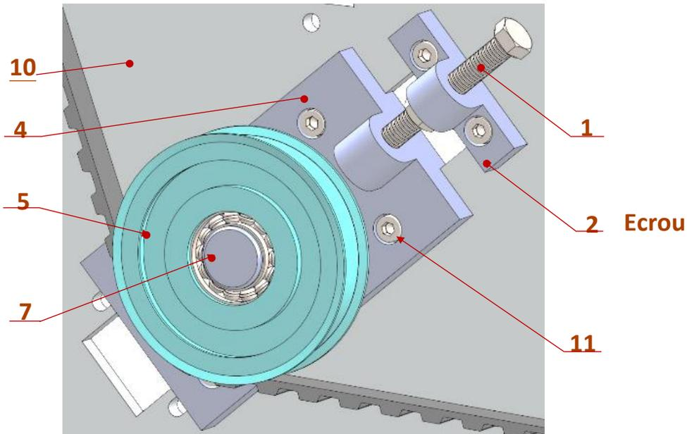
Dessin 2D du système tendeur de la courroie crantée (Courroie non représentée)
